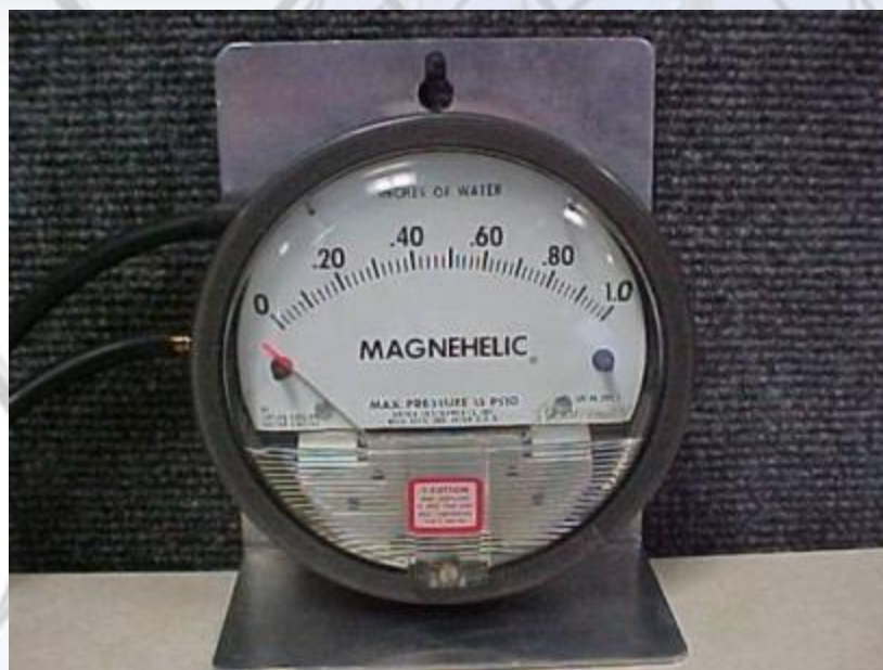
差动气压计：读取建筑物内环境压力。
