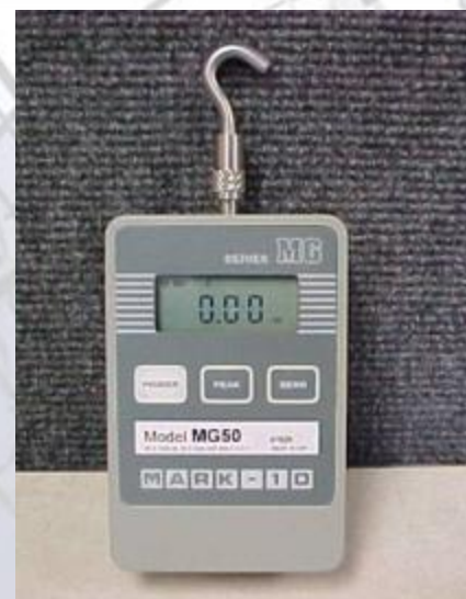
数字微压计：测量门闭合阻力
